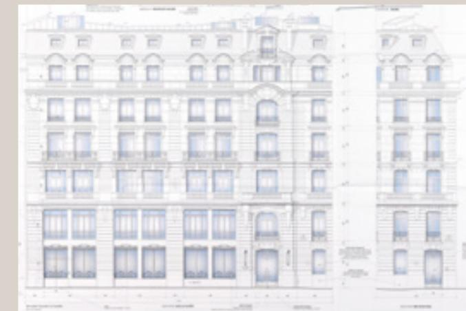
Élévation de la façade sur la rue La Fayette, état projeté. Le rez-de-chaussée retrouverait les grilles de serrurerie sur le modèle d'origine (© Agence MO<sup>2</sup>).
