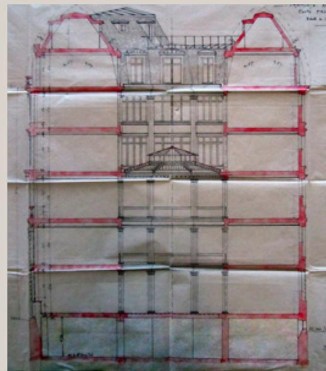
Coupe transversale où l'on devine le plancher de verre au centre du rez-de-chaussée, dressée par Ulmann en 1900 (Archives de Paris).
